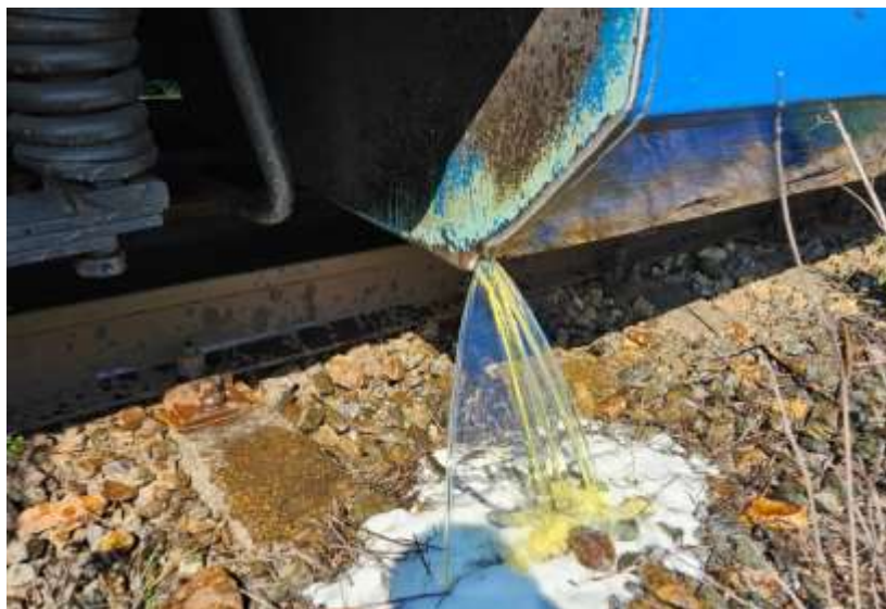
Imaginea nr.5 – Imagine cu poziția loviturii pe rezervorul locomotivei
