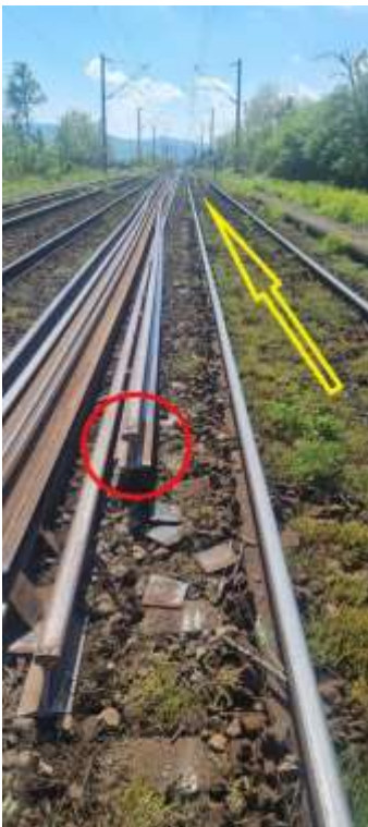
Imaginea nr.6– Imagine cu cuponul de șină care a produs incidentul (foto făcută de martor)
