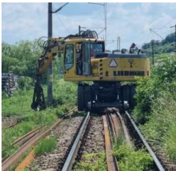
Imaginea nr.4 –mașina MSM folosită la scoaterea și depozitarea șinelor ( model)
