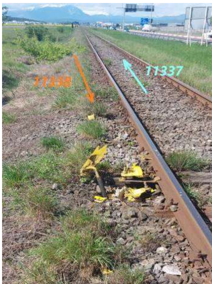
Foto nr.1 – inductorul spart
