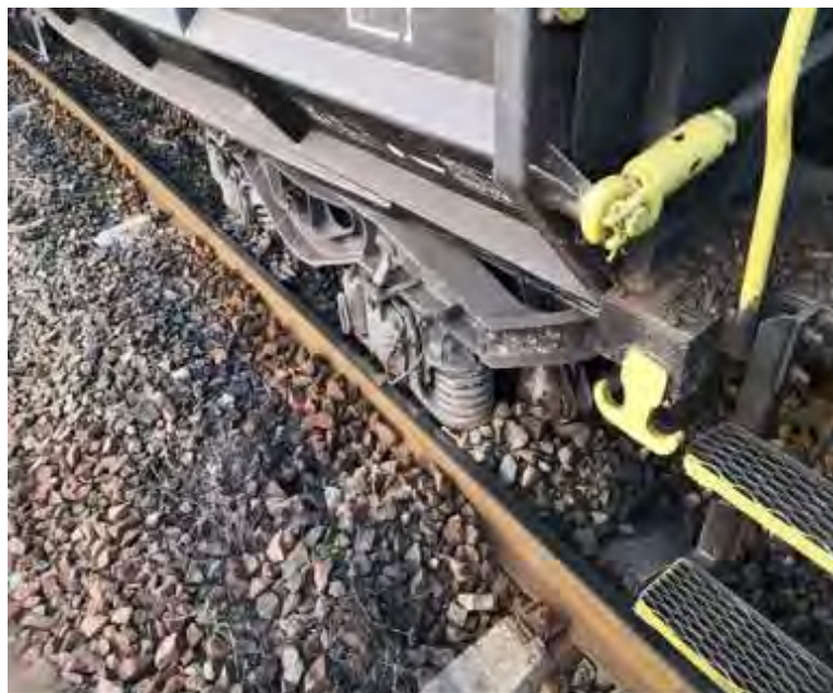
Foto nr.1: boghiul vagonului nr.81536653500-4 în stare deraiată.
