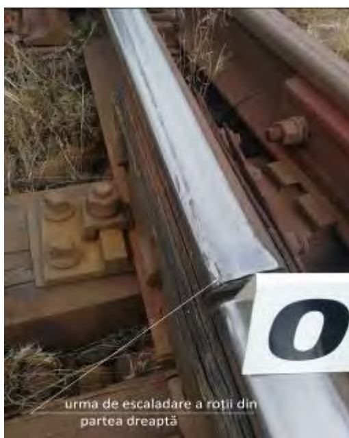
Foto nr.9 – urma de escaladare a roții din dreapta la joanta de capăt pe abaterea schimbătorului de cale nr.8
