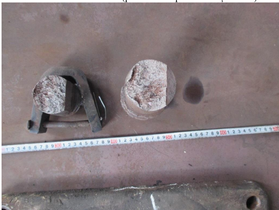
foto nr. 13 – pivotul crapodinei rupt de la boghiul aferent roților 5-8
