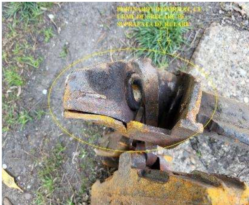
Foto nr.5 portsabotul aferent părții din față a roții R2 puternic deformat și cu urme de frecare puternică pe șină la partea inferioară.
