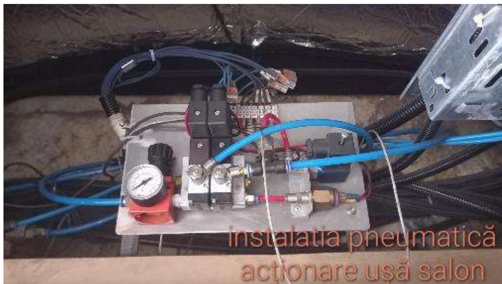
Imaginea nr.14 - Instalație pneumatică de acționare ușă salon de la un vagon similar
