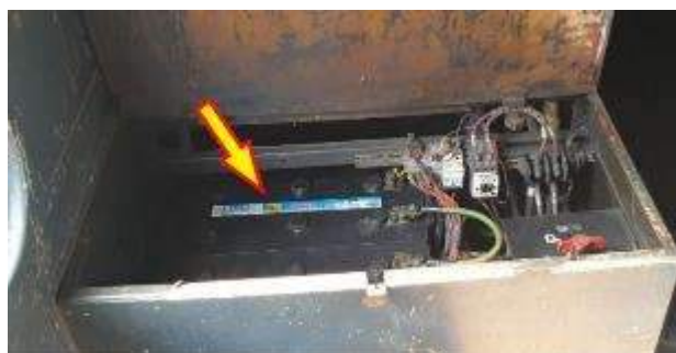
Imaginea nr.4 – acumulatorii de 24 V din lada amplasată în spațiul de bagaje (model)
