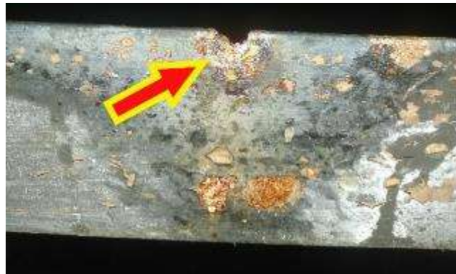
Imaginea nr.9 – detaliu cu material topit în platbanda din tablă de oțel
