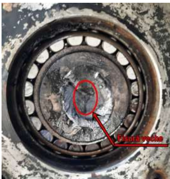
foto nr.5 – poziționarea zonei cu aspect de fisură veche
