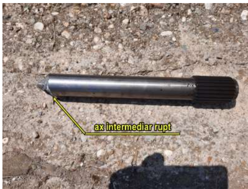
foto nr.3 - ax intermediar (planetar) rupt
