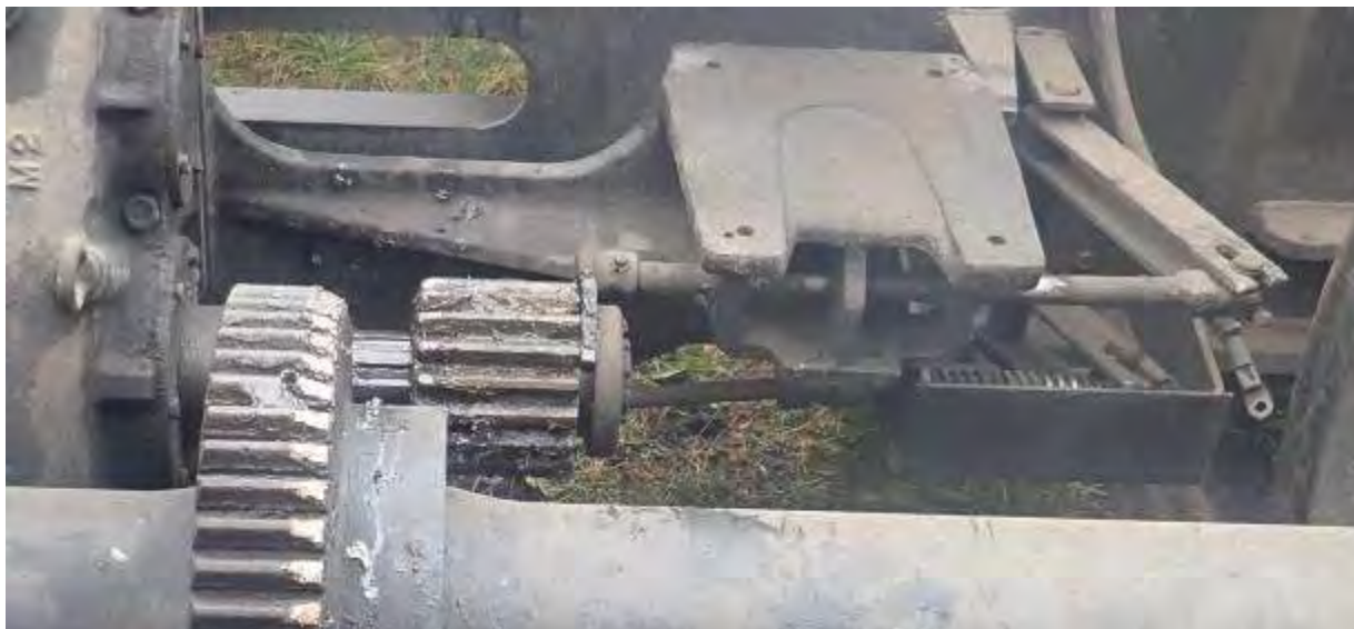
Foto nr.19 – stare pinion reductor anterior producerii accidentului, neasigurat suplimentar
