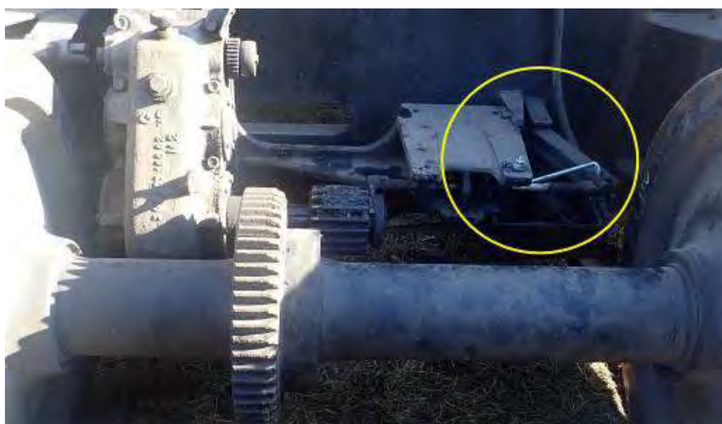
Foto nr.20 – stare pinion reductor după producerea accidentului, asigurat suplimentar
