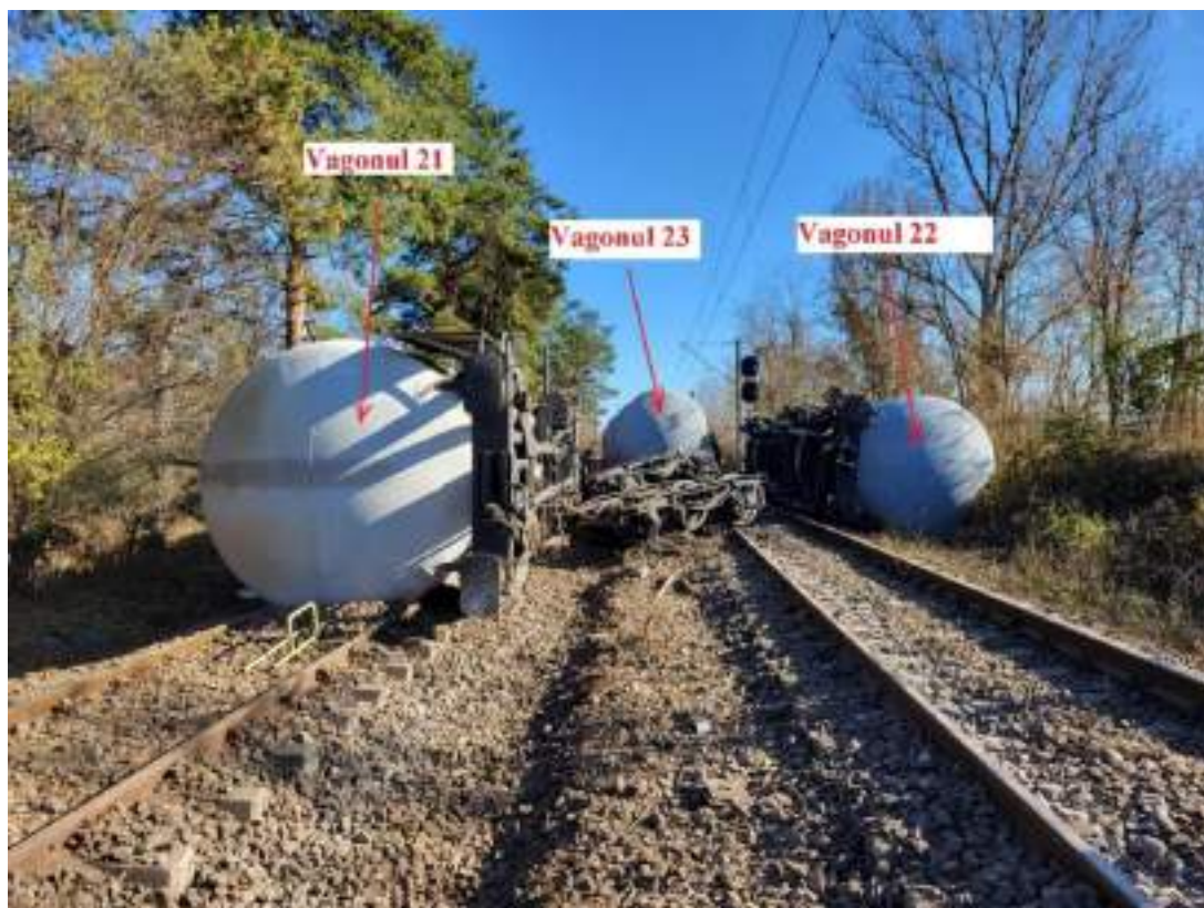
Foto nr.3 – poziția vagoanelor poziționate al 21-lea,22-lea și 23-lea, după deraiere
