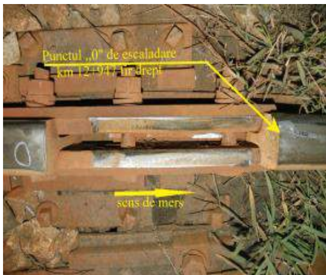
Foto nr.4: Punctul „0” - prima urmă de escaladare la km 12+947 (roata din dreapta a osiei nr.1)
