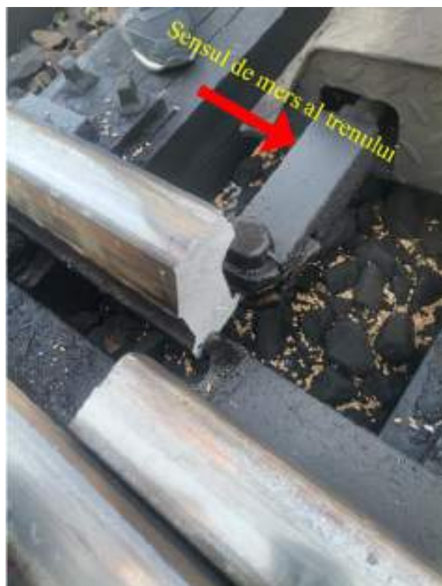
Foto nr.10 – Secțiunea de rupere a acului spre vârf ac Foto nr.11 – Secțiunea de rupere a acului spre călcâi
