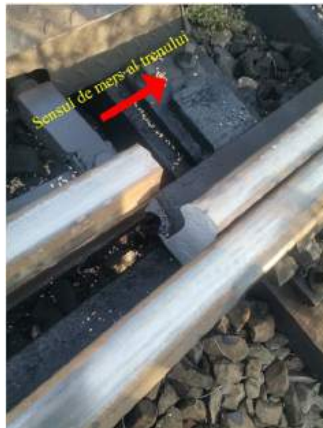
Foto nr.10 – Secțiunea de rupere a acului spre vârf ac Foto nr.11 – Secțiunea de rupere a acului spre călcâi
