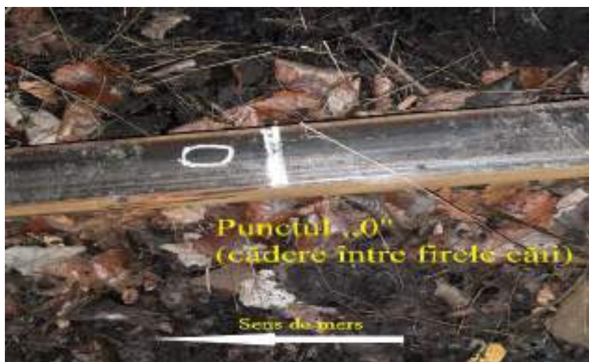
Imaginea nr. 5 – punctul „0” prima urmă de căderea roții din partea dreaptă, între firele căii
