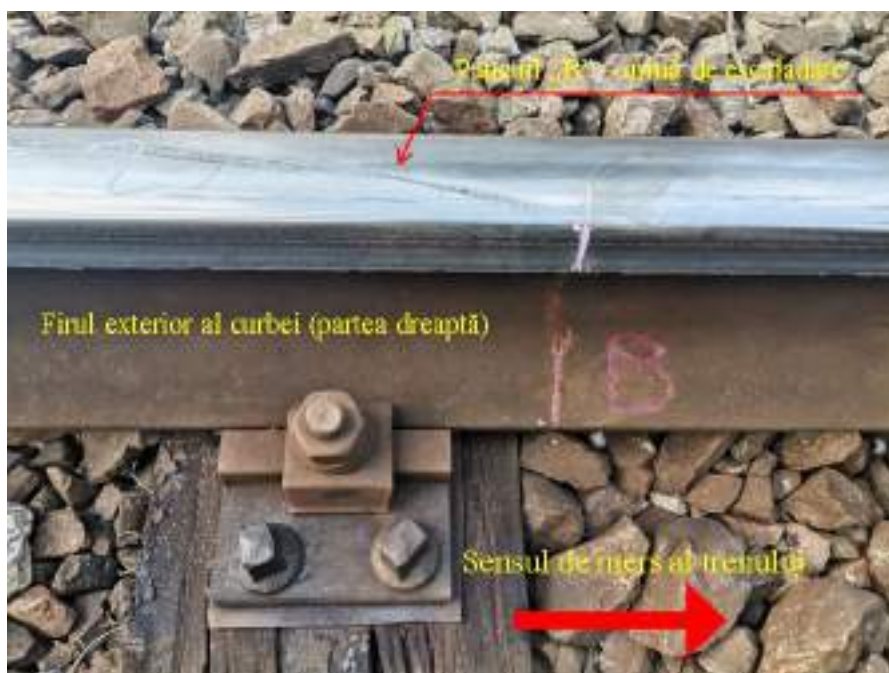
Foto. nr.3 – Punctul „B”: urmă de escaladare pe firul exterior al curbei
