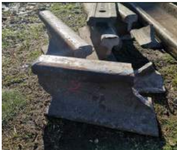
Foto nr.11 și 12. Fragmente din șina de pe firul din partea dreaptă ruptă în diverse secțiuni
