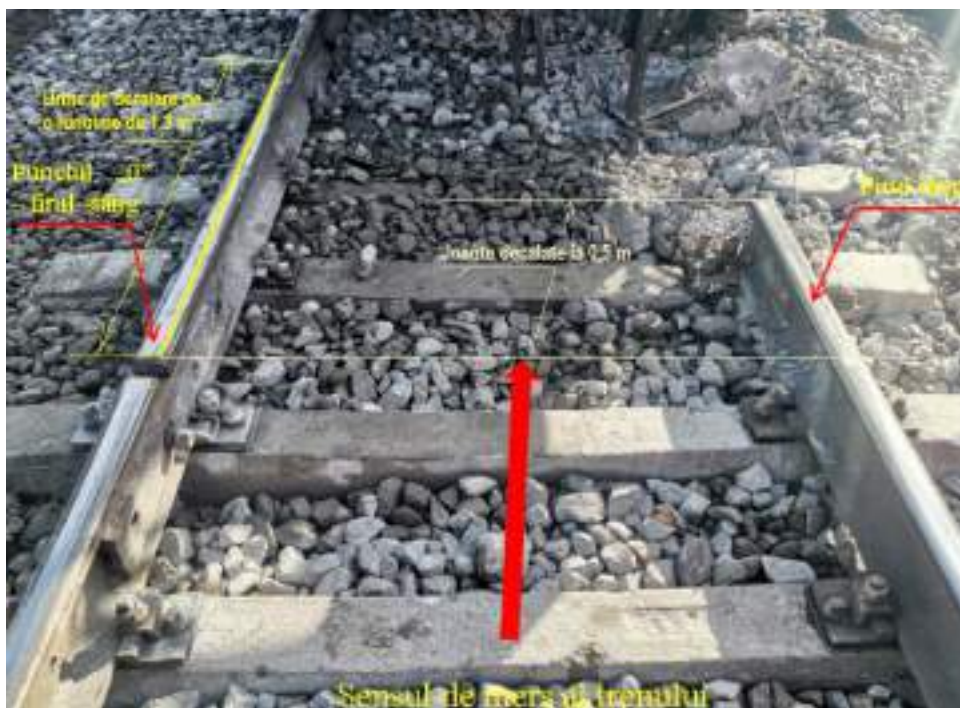
Figura nr.2. Schița cu urme și poziționarea joantelor
