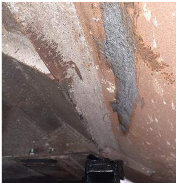
Foto nr. 4 Prelungire panta fixă cu urme de frecare ale ramei boghiului
