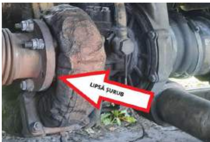
Imaginea nr.16 – Flanșa de la turbosuflantă cu șurub și piuliță lipsă
