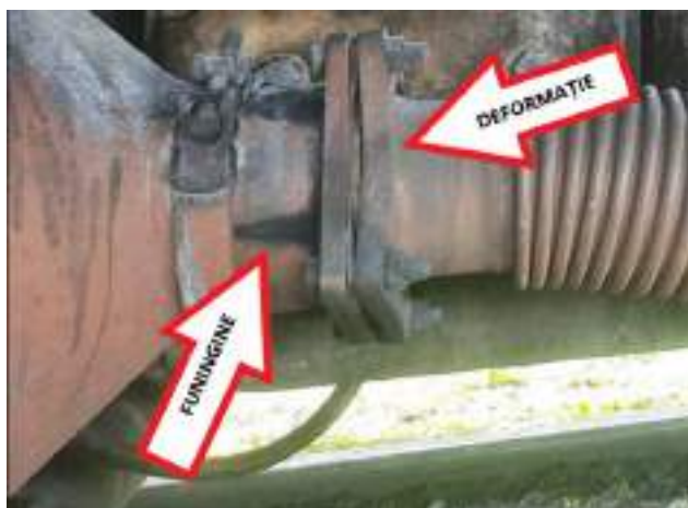
Imaginea nr.15 – Flanșa de la filtrul de particule era deformată și prezenta funingine de la gazele arse provenite din instalația de evacuare
