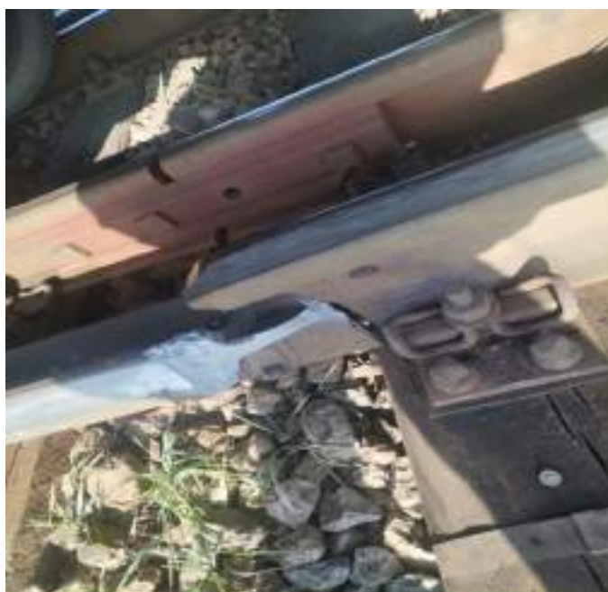
Foto nr.15 – sudura ruptă dintre șina de legătură și contraacul drept al schimbătorului de cale nr.1
