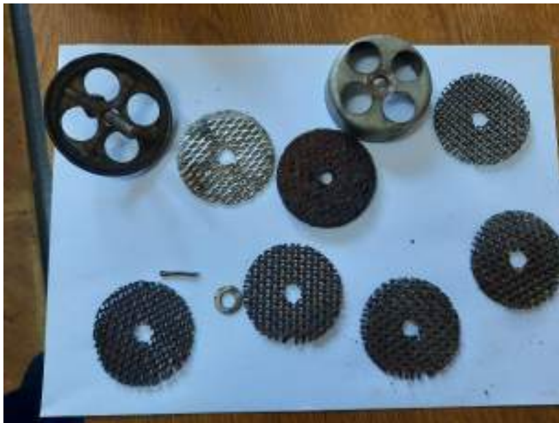
Foto nr.7 - impurități în filtrul distribuitorului de aer
