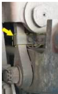
Imagine – colier de siguranță aplicată pe brida pendulară (model)
