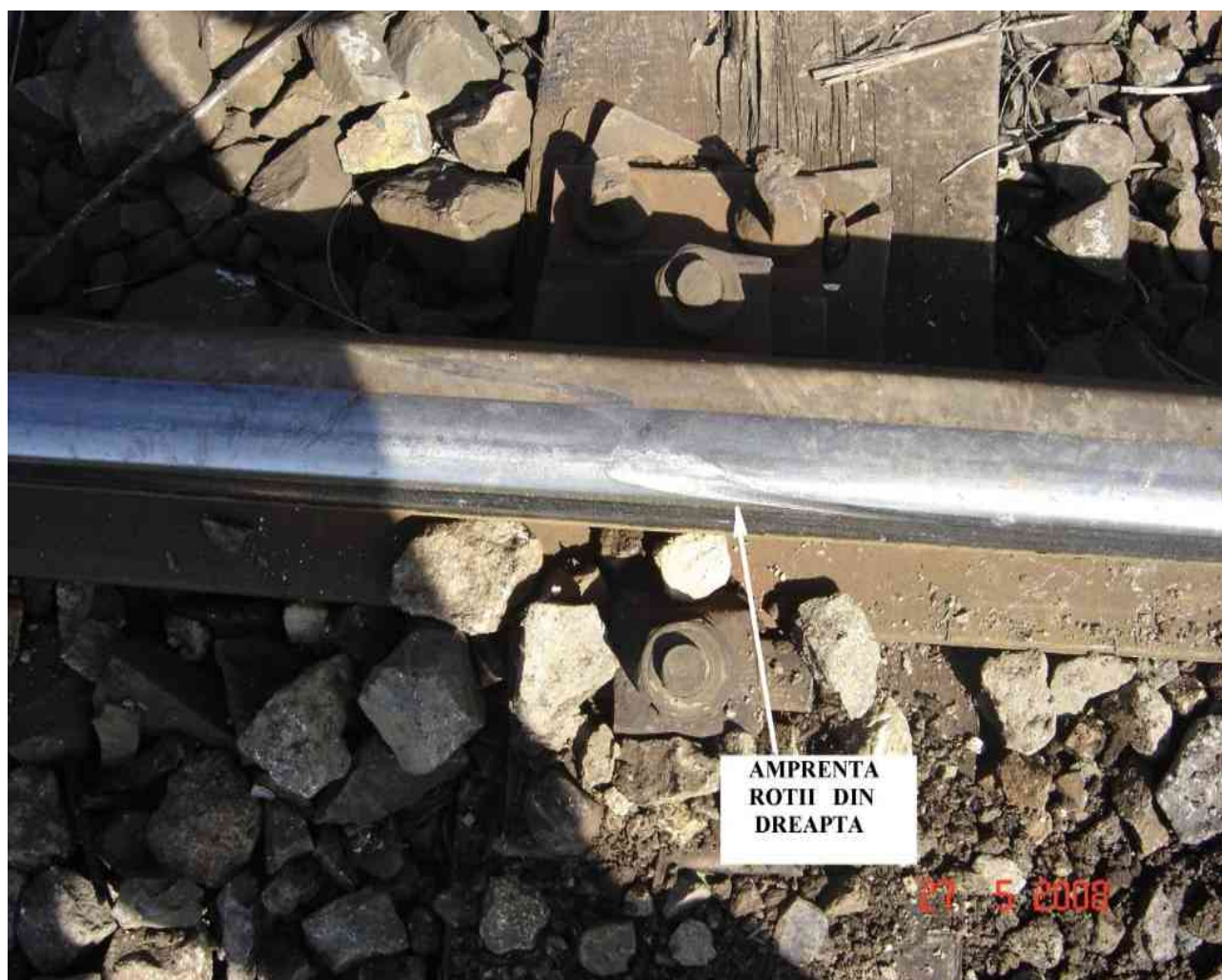
Figura 4. AMPRENTA ROTII DIN DREAPTA PE ȘINA DE LEGATURA ÎNAINTE DE DERAIERE ÎN EXTERIORUL CĂII ÎN ABATERE
