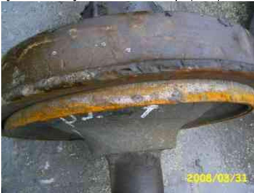
Figura 2 – roata nr. 2 a vagonului nr. 8853 6656 620-0 cu bandajul deplasat de pe obadă
